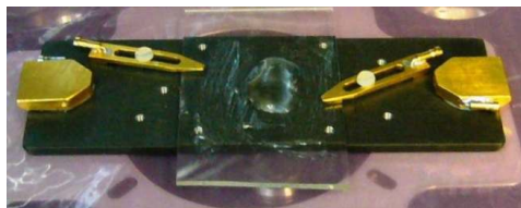
(d) Grease barrier on a slide.
